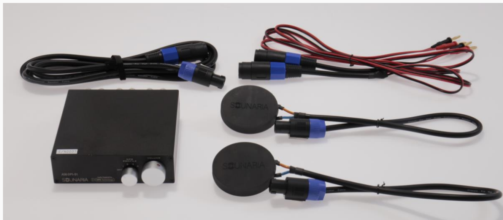
【貸出セット全体写真】 DPS AMP 本体／エキサイター／接続ケーブル
